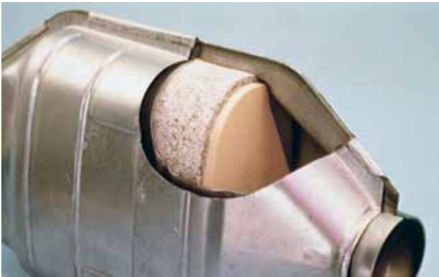
الصورة ٩-٧ تقلل المحولات المحفزة من الملوثات المنبعثة من عوادم المركبات.
