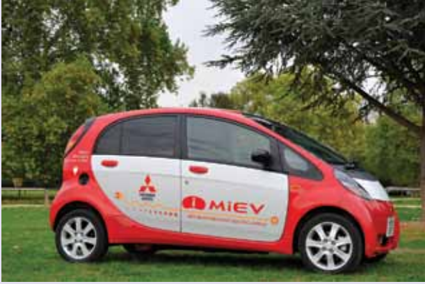
الصورة ٧-١ سيارة كهربائية، يتم تزويدها بالطاقة بواسطة بطارية ليثيوم-أيون.
